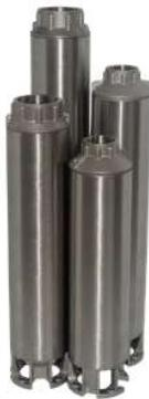
Pompe sommerse multistadio a norme NEMA, adatte al pompaggio di acqua pulita da pozzi profondi di 4" in settori domestici, agricoli ed industriali, in sistemi di pressurizzazione ed impianti di irrigazione. Le pompe della serie AX-BX-CCX-FX sono di tipo radiale (mandata standard = 1,25"), le pompe della serie KX-LX-MX-QX sono di tipo semi-assiale (mandata = 2"). Le pompe con più di 30 giranti hanno l'albero diviso in due per migliorare resistenza ed efficienza.
